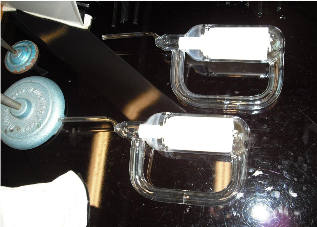
Die weißen Keramikrohre sollen die Strahlungswärme der Heizung aufnehmen und an das Kaliumgas übertragen. Quarzglas ist ein schlechter Wärmeleiter während Strahlung in einem breiten Frequenzbereich durchstrahlt. von UV bis ca. 4000nm ist Quarzglas transparent und strahlt auch in dem Bandbereich nicht.
