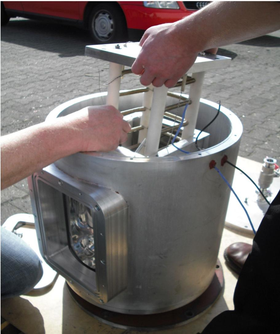
Einbau der Heizung. Sie umgibt den Quarzglasring. Warum draußen ? Es bestand die Angst vor einem Brand des Aluminiums bei den hohen angestrebten Temperaturen. Hat sich nicht bestätigt.
