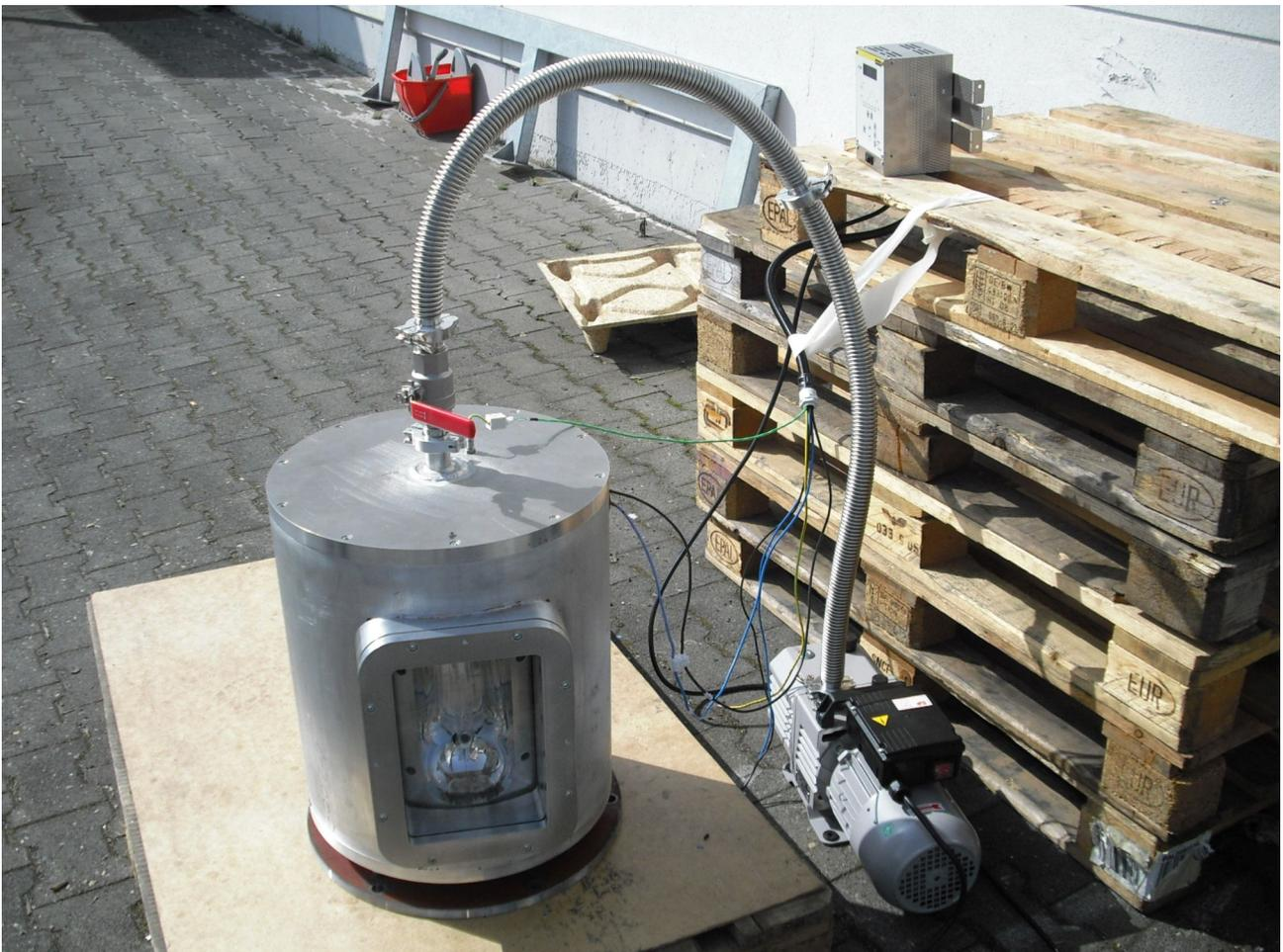
Alles ist angeschlossen. Das grüne Kabel ist die Zuleitung zum Thermometer welches in die Heizung ragt. Der Kasten oben auf dem Palettenstapel ist die Heizungssteuerung. Da sich alles im Vakuum befindet kann nur die durch die Strahlung erreichte Temperatur am Messfühler gemessen werden.
